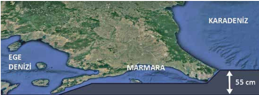
Resim 4: Karadeniz'in yüzey seviyesi ortalama olarak Ege'den 55 cm daha yüksektir ve bu fark en çok İstanbul Boğazı'nda kendini gösterir.
