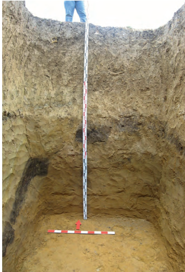
Res. 88: 2. sondajda yatayda ani bir kırılma ve kopma izi gösteren koyu renkli bir tabakaya rastlanılması bölgedeki depremselliği tetikleyen küçük fayların varlığını bir kez daha akla getirmiştir.
